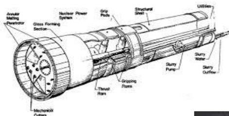
**En torno a la tuneladora,** el calor es suministrado por un reactor nuclear compacto que difunde el litio líquido del corazón del reactor en la cara del túnel, donde está poco a poco derrite la roca. En el proceso del derretimiento de la roca el litio
